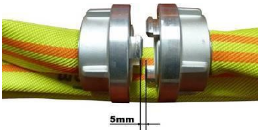
Bild 1: Kupplungsabstand beim Löschangriff
